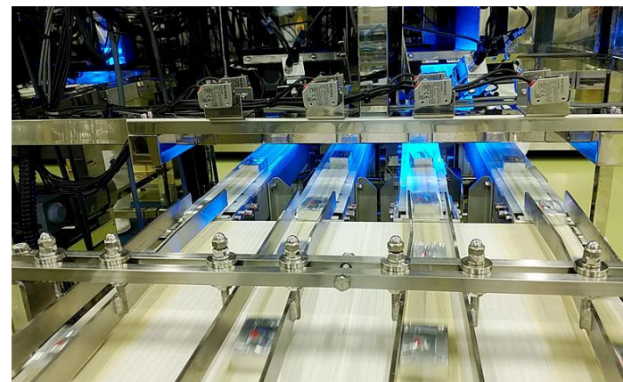
AI検査装置で省力化を実現(神戸工場)
